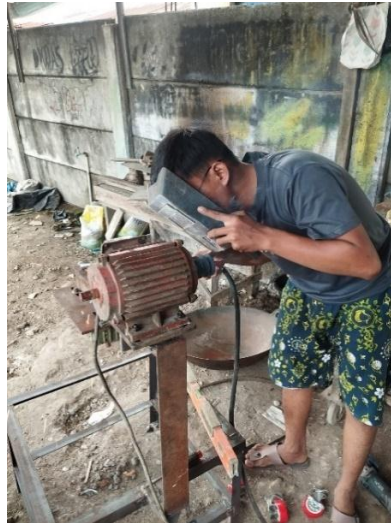
Gambar 4.5 Proses pemasanganudukan gear box dan motoran
