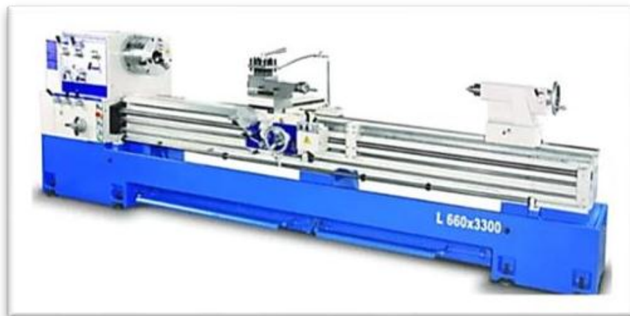
Gambar 2.4 Mesin bubut meja panjang (Nado, Orlando Mardiro Poeng, 2018)
