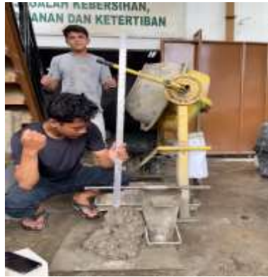
L1 : Pengujian slump
