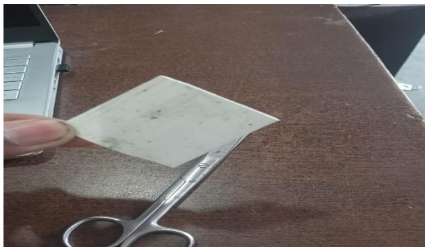
Gambar 4.3 Plastik PVC dipotong dengan ukuran 2x2
