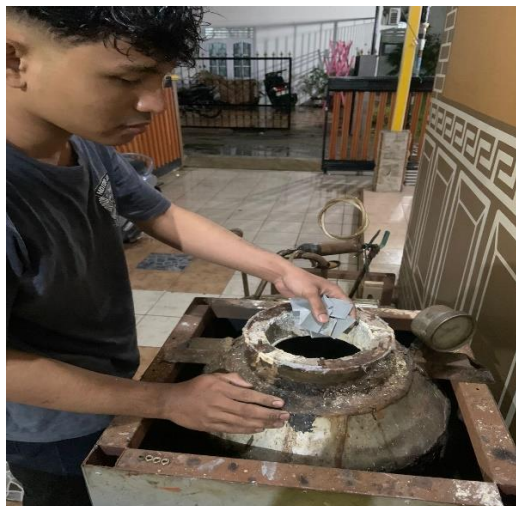
Gambar 4.6 limbah dimasukkan kedalam reaktor
