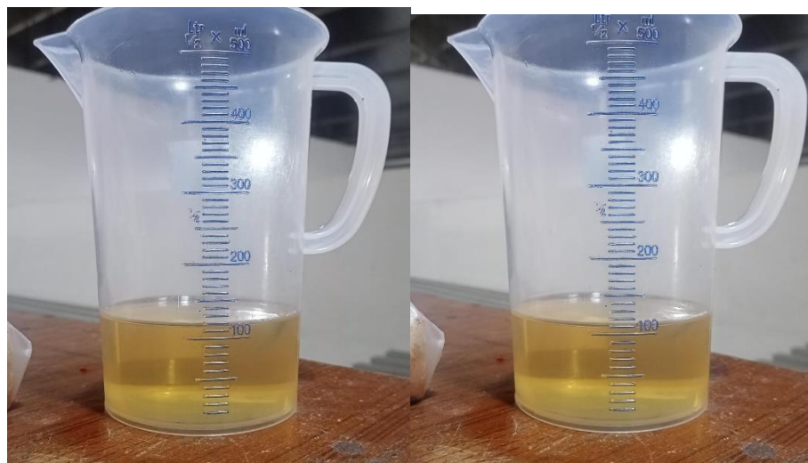
Gambar 4.12 minyak pvc dengan campuran 20% zat aditif carbon cleaner(kiri) dan minyak pvc dengan campuran 10% zat aditif carbon cleaner(kanan)
