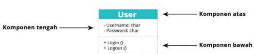
Gambar 2. 1 Komponen dalam Class Diagram
