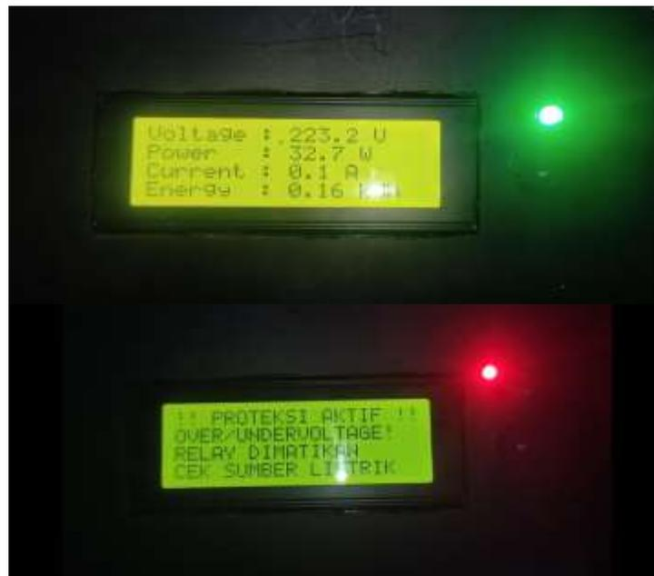
**Gambar 4.9 Tampilan LCD pada Pengujian over/undervoltage**
