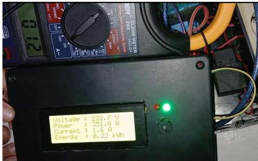
**Gambar 4.17 Perbandingan Arus pada PZEM dengan Clamp Meter**
