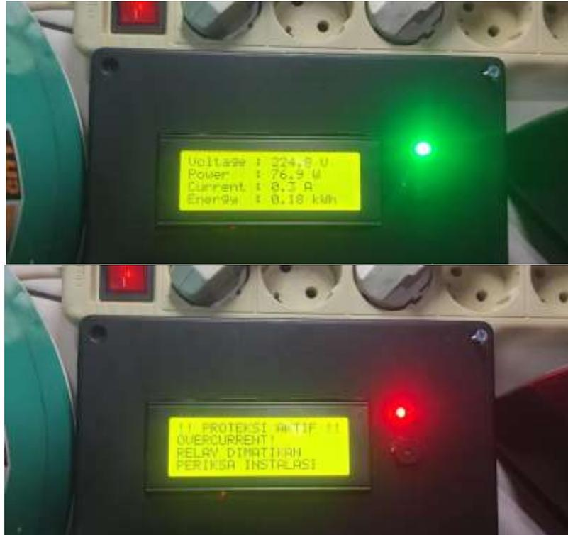
**Gambar 4.7 Tampilan LCD pada Pengujian Overcurrent**
