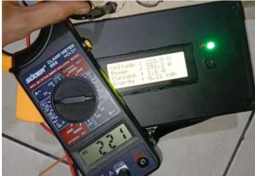
**Gambar 4.16 Perbandingan Tegangan pada PZEM dengan Clamp Meter**
