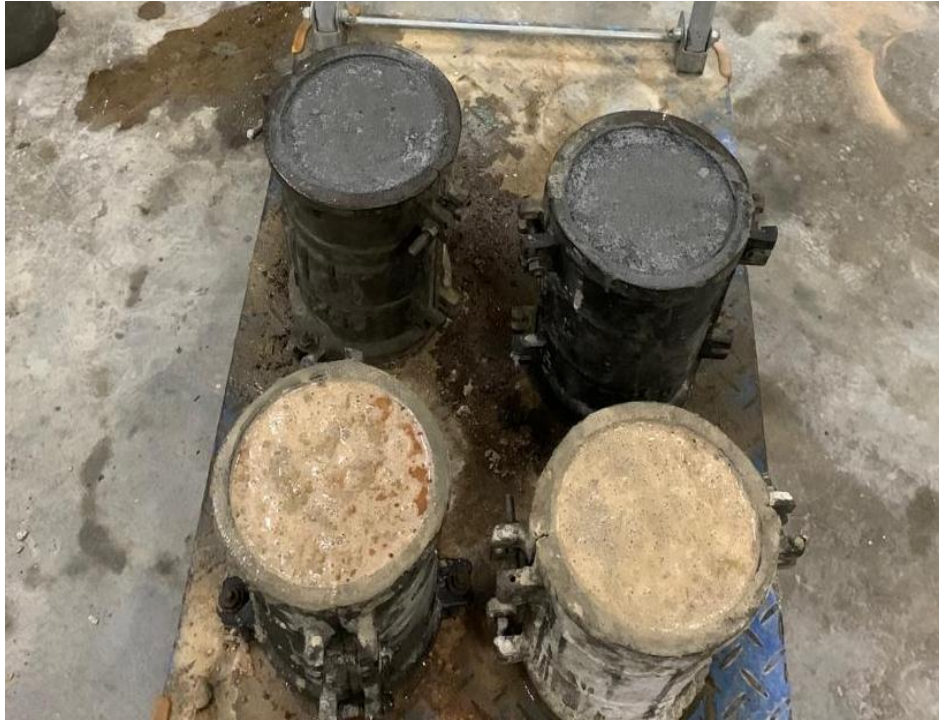
Gambar L.7: Beton segar dimasukkan ke dalam bekisting
