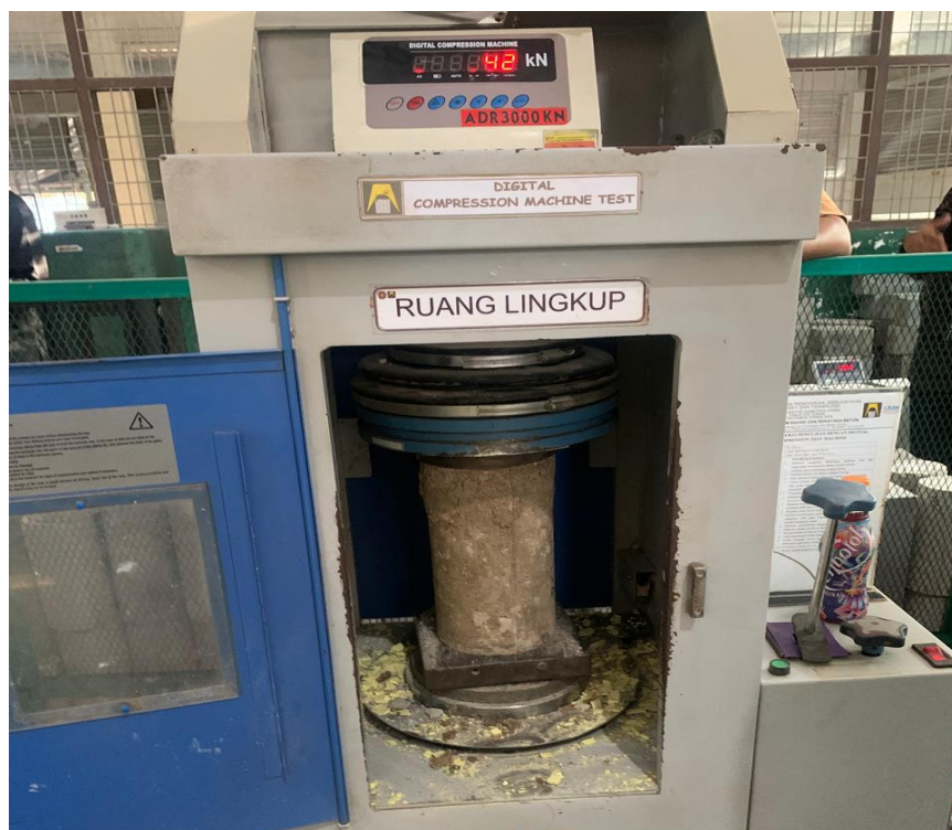
Gambar L.10: Pengujian kuat tekan beton
