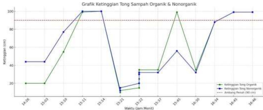
Gambar 4.6 Hasil Pemantauan Ketinggian Tong Sampah Organik & Nonorganik secara Real-Time
