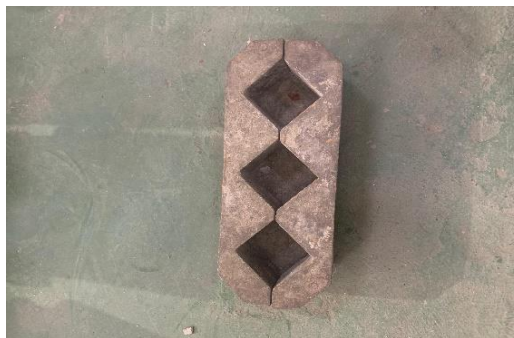
Gambar 3.8: Cetakan ukuran 5\text{ cm} \times 5\text{ cm} \times 5\text{ cm} .
