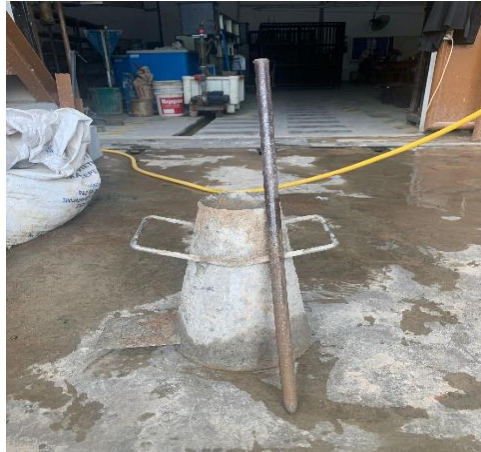
Gambar 3.7: Cetakan kerucut pasir dan tongkat pemadat.
