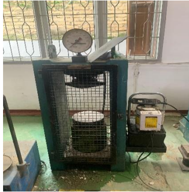
Gambar 3.11: Mesin pengujian kuat tekan.
