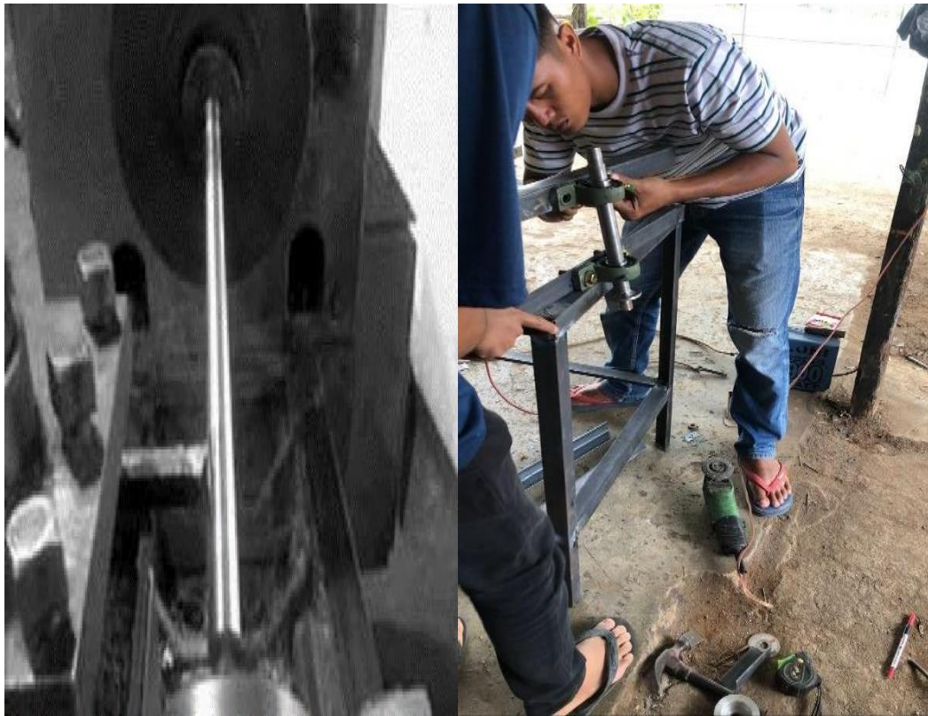
Gambar 4.1 Pembuatan Porors dan Pemasangan Poros
