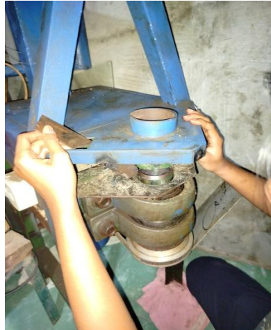
Gambar 4.4 Pemasangan Mata Pisau High Speed Steel (HSS)
