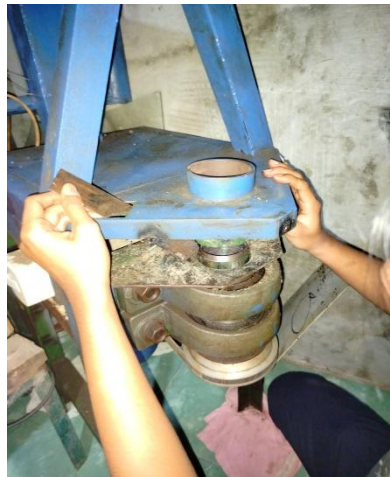
Pemasangan Mata Pisau High Speed Steel (HSS)
