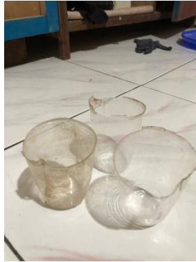
Gambar 4.14 Hasil Pemotongan Dengan Mata Pisau Stainless Steel
