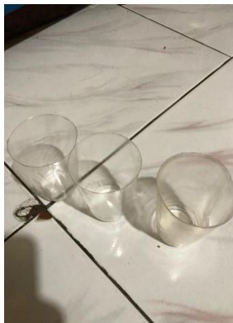
Gambar 4.9 Hasil Pemotongan Dengan Mata Pisau HSS ( High-Speed Steel )
