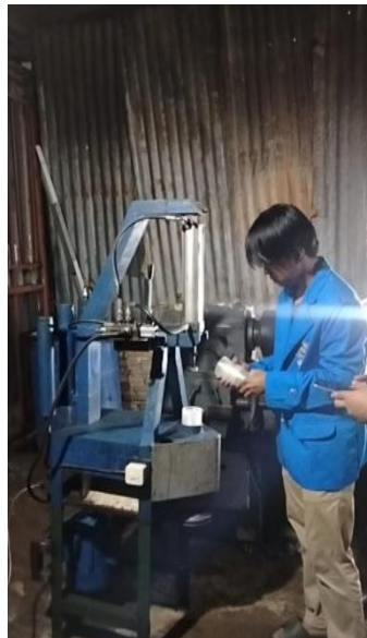
Gambar 4. 11 Proses Pemotongan Dengan Mat Pisau Stainless Steel
