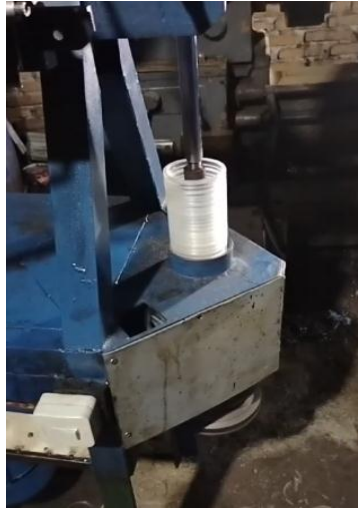
Gambar 4.6 Proses Pemotongan Dengan Mata Pisau HSS ( High-Speed Steel )
