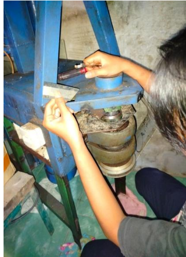
Gambar 4.5 Pemasangan Mata Pisau Stainless Steel
