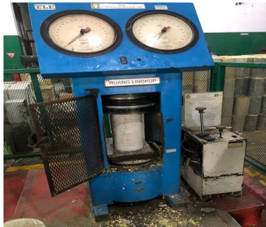
Gambar L11: Pengujian kuat tekan beton
