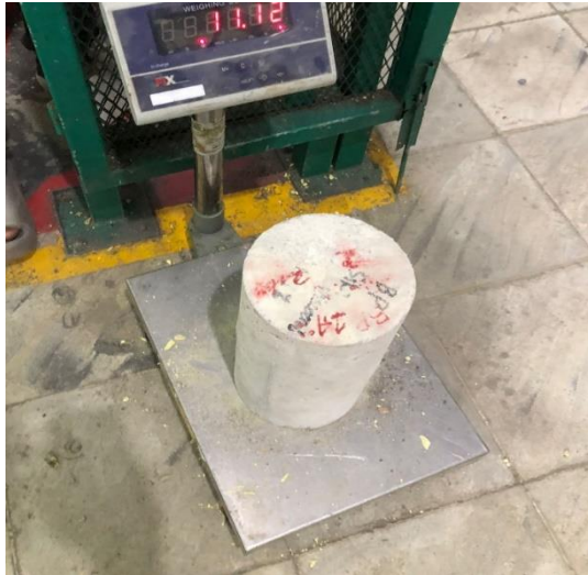
Gambar L10: Penimbangan benda uji
