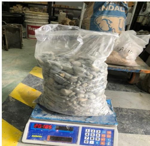
Gambar L8: Penimbangan agregat kasar
