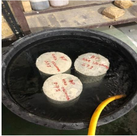
Gambar L4: Perendaman Benda uji
