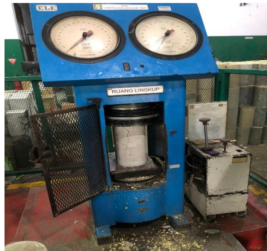
Gambar 3.5: Ilustrasi uji kuat tekan beton
