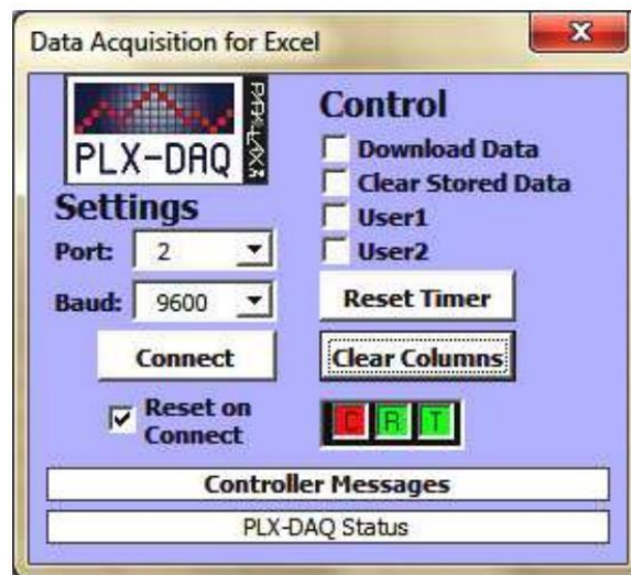
Gambar 2.19 Program PLX-DAQ untuk komunikasi interface (González-Arjona, D., et al. 2013)
