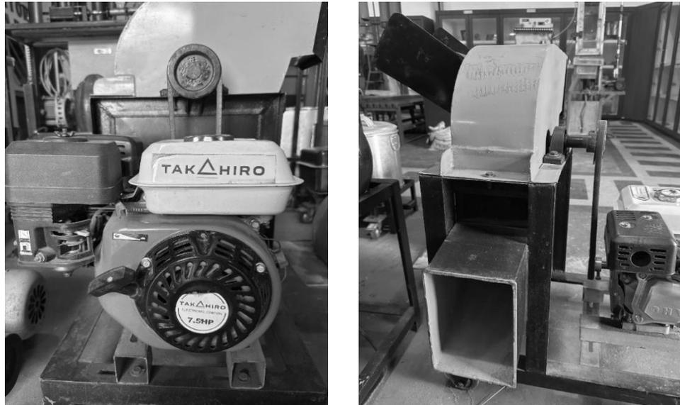
Gambar 4.2 Mesin pencacah pelepah kelapa sawit.
