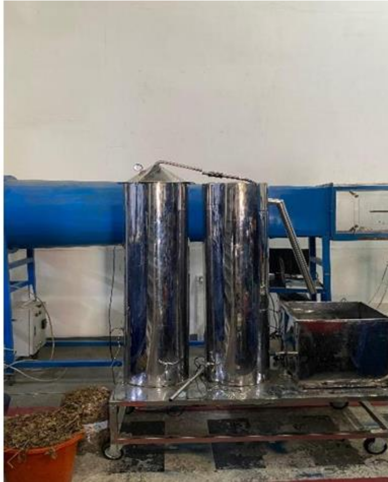
Gambar 3. 14 Alat Penyulingan Daun Nilam Kapasitas 5 Kg
