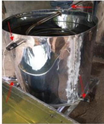
Gambar 3.19 meletakkan thermocouple pada kondensor
