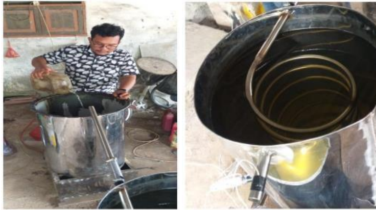
Gambar 3.15 memasukkan air kedalam ketel dan kondensor
