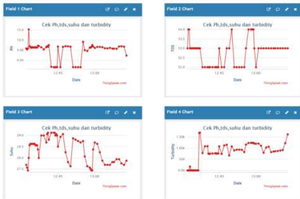
Gambar 4.7 Grafik Nilai pH, TDS, Suhu, Turbidity Air Sumur pada Data grafik ini kemudian diunduh dari ThingSpeak dalam format Excel untuk dilakukan analisis lebih lanjut menggunakan metode TOPSIS, yang akan dijelaskan pada subbab berikutnya.
