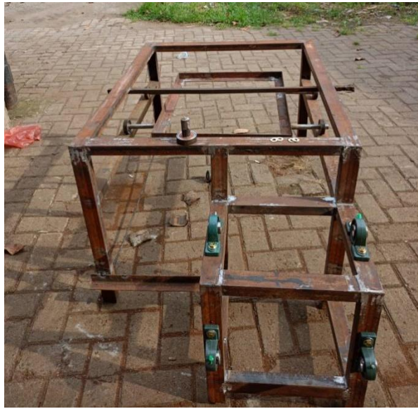
Gambar 2.7 Rangka Mesin Pengayak tepung Biji Durian
