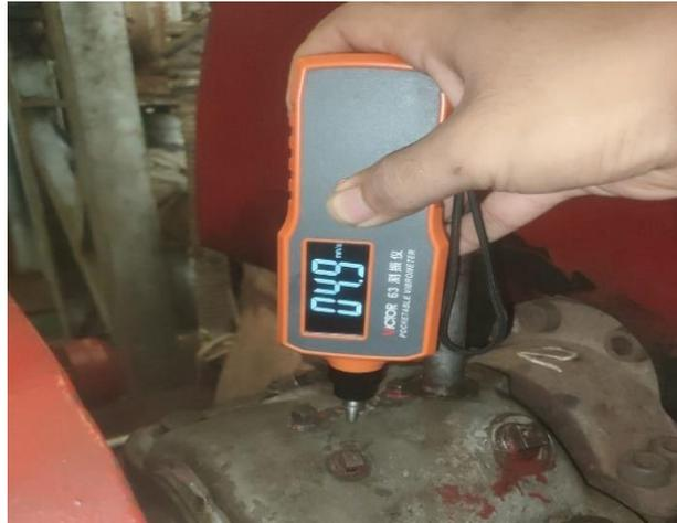
Gambar 4. 8 Pengukuran Vibrasi Bearing 2 jam 20.00
