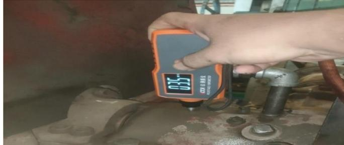
Gambar 4. 1 pengukuran Vibrasi Bearing 1 jam 10.00
