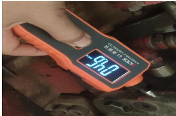
Gambar 4. 7 Pengukuran Vibrasi Bearing 1 jam 20.00
