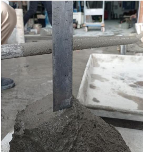
Gambar L 8. Pengujian *Slump*
