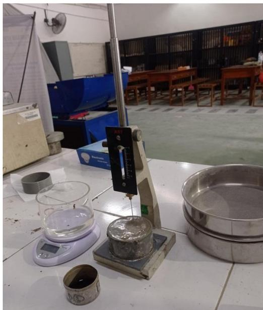
Gambar L 11. Pengujian *Setting Time*
