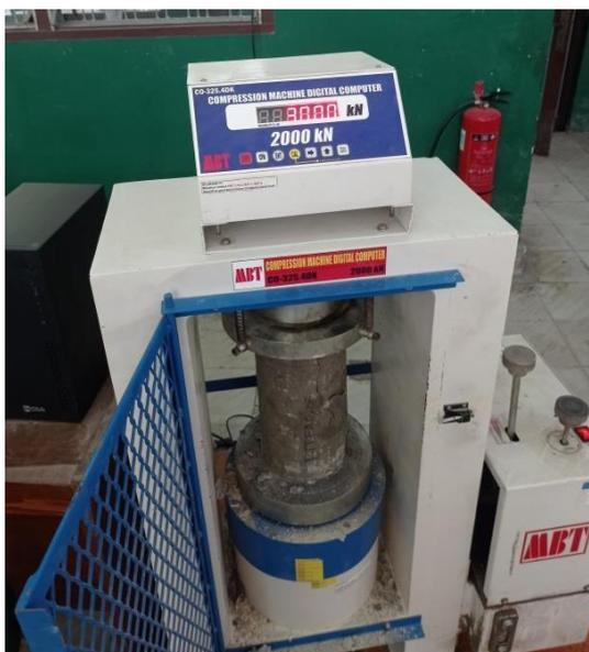
Gambar L 10. Pengujian Kuat Tekan Beton
