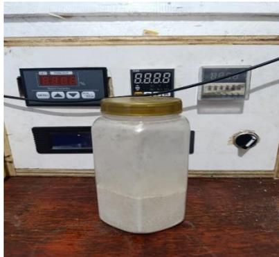
Gambar 3. 16 Katalis heterogen (kalsium oksida dari cangkang langkitang)
