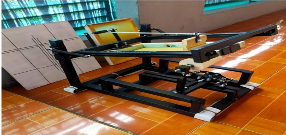
Gambar 2.1 mesin sablon cup manual (CV MUSTIKA UTAMA. 2025 )
