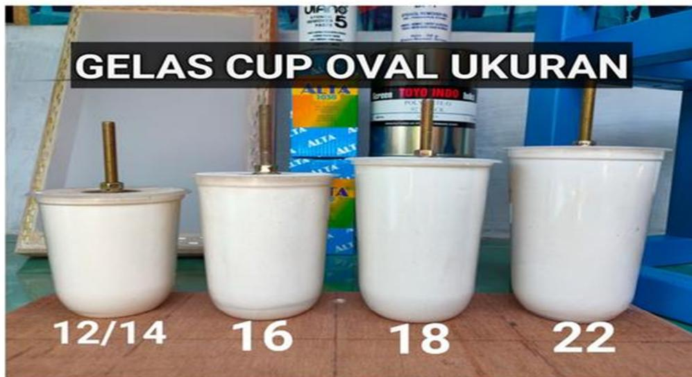
Gambar 3.8 Mandrel atau moulding
