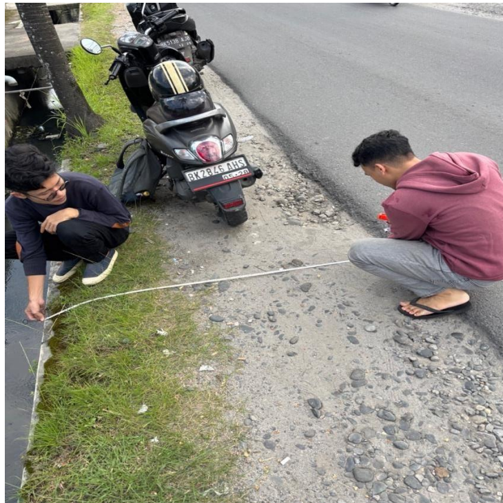
Gambar L2 : Pengukuran Lebar Bahu Jalan
