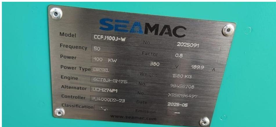
Gambar 4.3 Identifikasi nameplate Generator Set Kapal Tugboat
