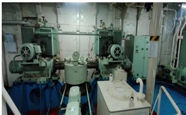
Gambar 2.12 Steering gear pada kapal.
