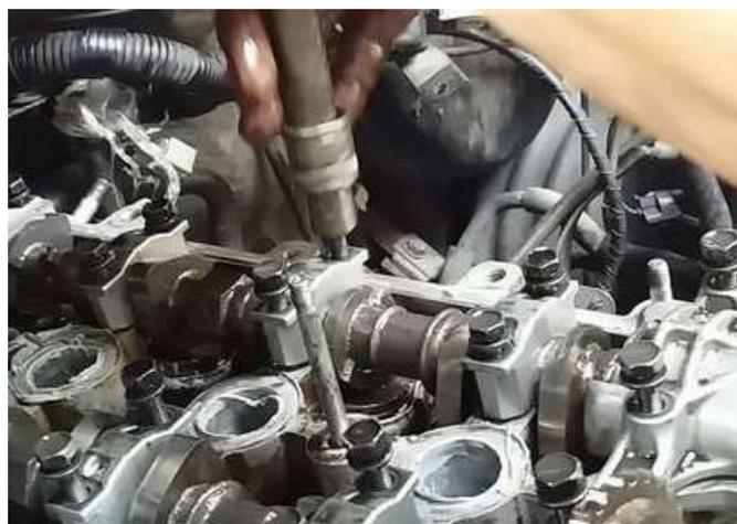
Gambar 2.18 Melepas *injector* dari *cylinder head*
