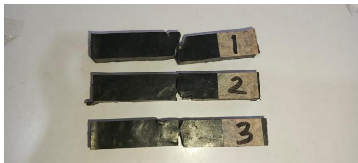
Gambar 4. 43 Hasil patahan spesimen impact 3
