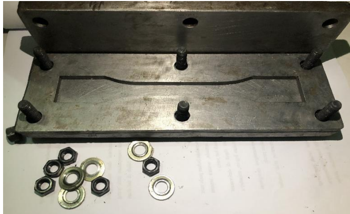
Gambar 3. 2 Cetakan Spesimen Uji Tarik
