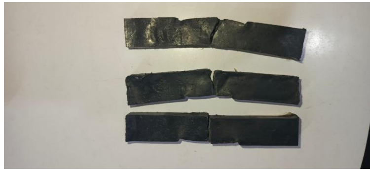
Gambar 4. 41 Hasi patahan spesimen impact 2
