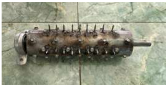
Gambar 4.2 Poros dan penyusunan mata pengurai Sumber : (Dokumen pribadi)
