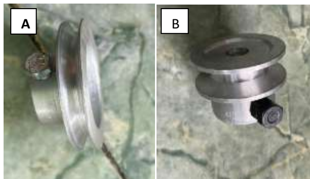
Gambar 3.5(A) Pulley atas 56 mm dan (B) pulley bawah 48mm
