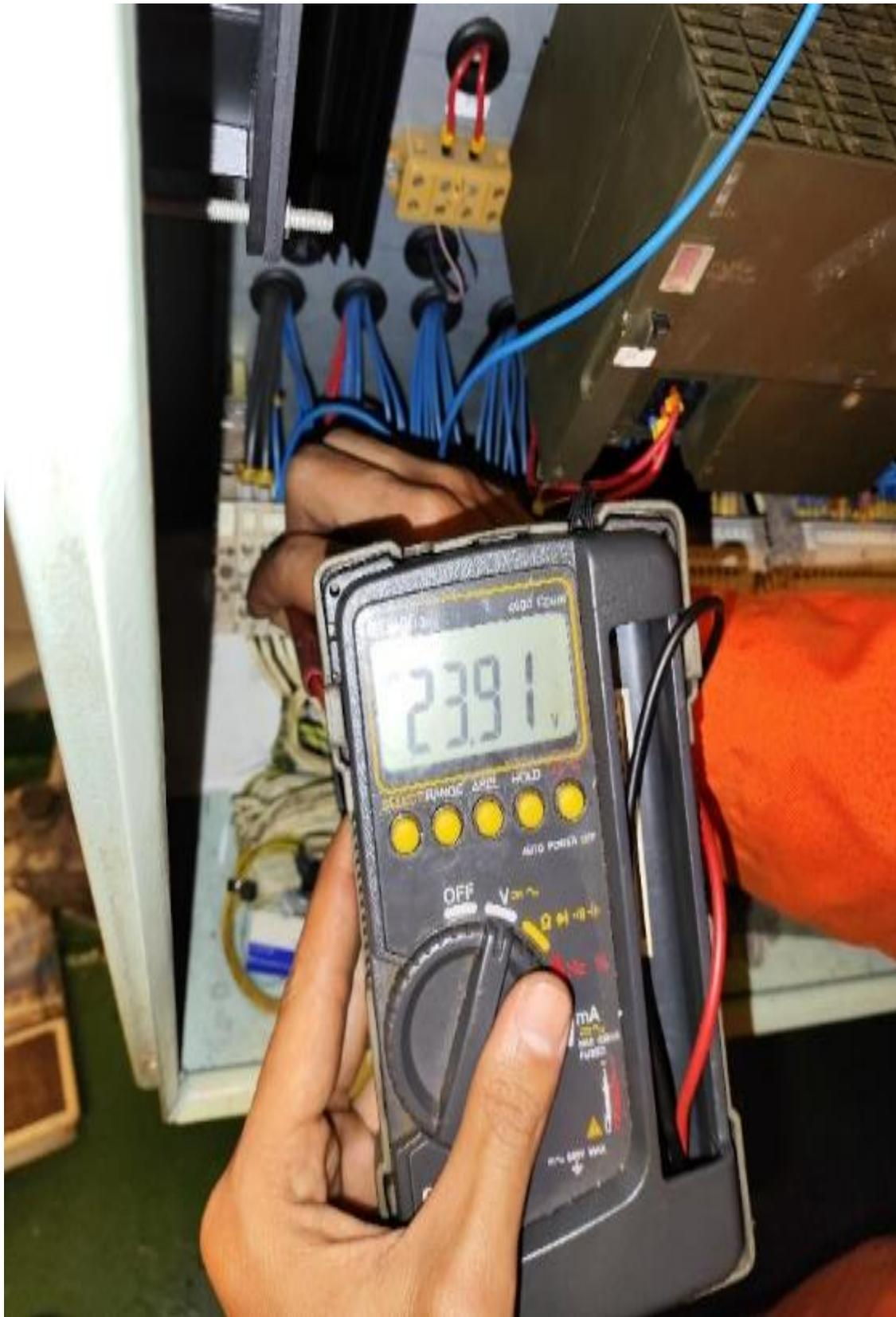
Gambar 5 Tegangan Operasional (*Parameter Water Level*)
