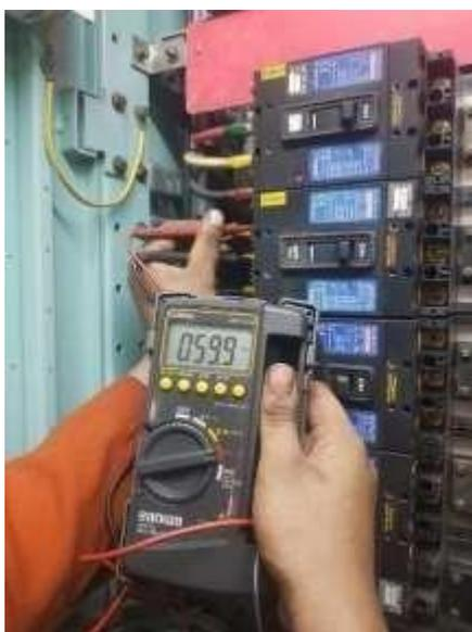
**Gambar 4. 3** Pengukuran Frekuensi Pada Beban Feeder 440 VAC
