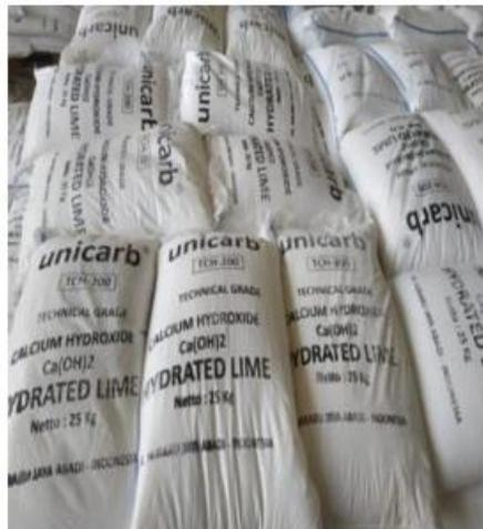
Gambar 3.5: Kalsium hidroksida Ca(OH)<sub>2</sub>.
