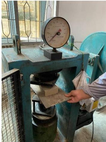
Gambar 4.13: Proses pengujian kuat tekan bata.
