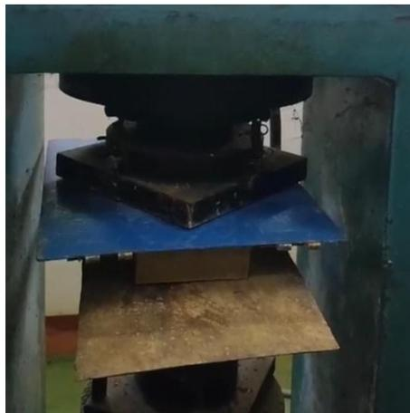
Gambar 4.10: Proses pengujian kuat tekan bata tanpa bakar.
