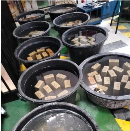
Gambar 4.5: Proses perendaman bata di dalam air.
