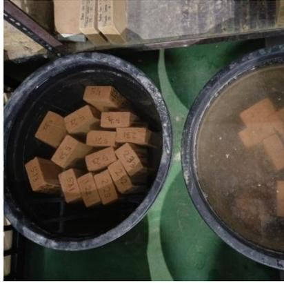
Gambar 4.16: Pengujian daya tahan bata tanpa bakar.
