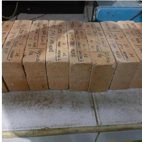
Gambar 4.8: Hasil pengujian kadar garam bata.
