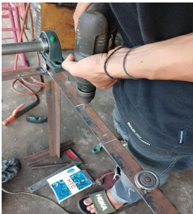
Gambar 4. 17 Proses Penyambungan baut
