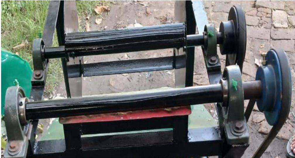
Gambar 4. 19 Pemasangan Poros Dan *Pulley*
