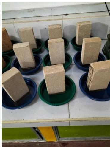
Gambar 4. 5 : Proses Pengujian Kadar Garam
