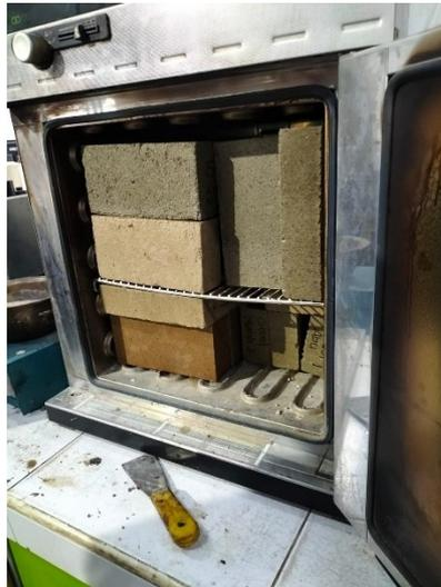
Gambar 4.15 : Pengeringan Benda Uji Dengan Oven Selama 24 Jam
