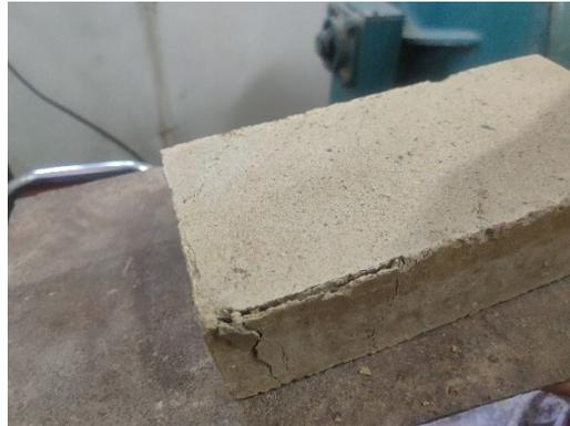
Gambar 4.12 : Setelah Pengujian Kuar Tekan
