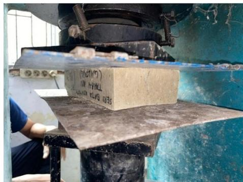
Gambar 4.11 : Proses Pengujian Kuat Tekan
