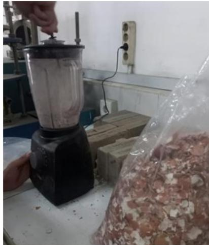
Gambar 3. 19 : Proses Menghaluskan Cangkang Telur
