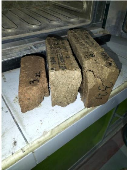
Gambar 4.16 : Benda Uji Yang Mengalami Kehancuran Akibat Pengujian Daya Tahan
