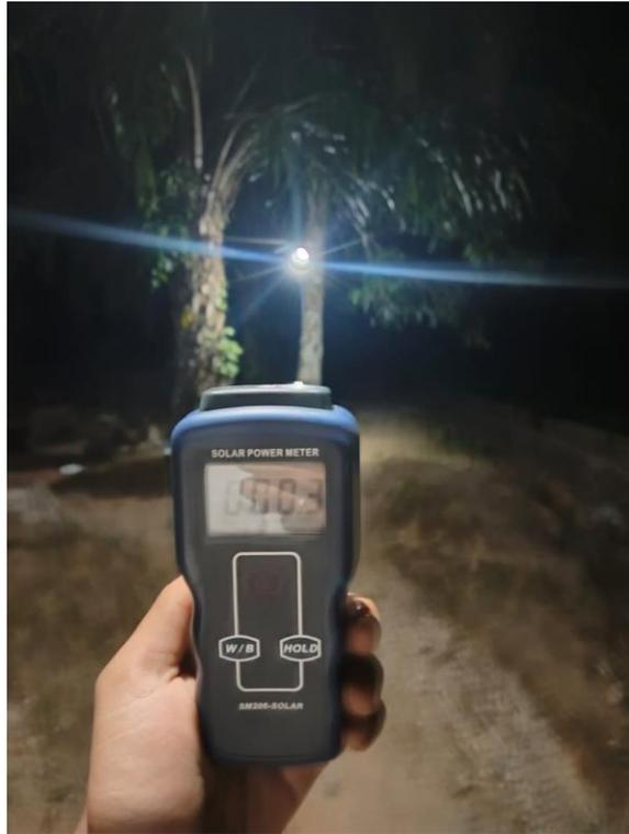
Dengan demikian, nilai rata-rata 17 lux dipandang lebih representatif untuk menggambarkan tingkat pencahayaan yang benar-benar diterima pada permukaan di jarak 6 meter. Hasil pengukuran ini dijadikan acuan dalam analisis kinerja sistem PLTS Off-Grid untuk penerangan jembatan miniatur pada penelitian di Jorong Lubuk Gobing.
