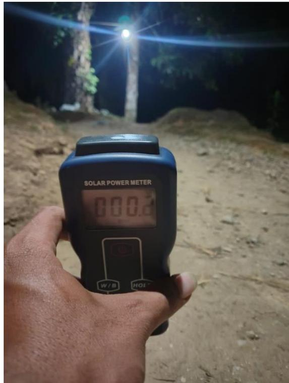
Berdasarkan pengukuran, alat menunjukkan nilai intensitas radiasi sebesar 0,2 hingga 0,3  $W/m^2$ , yang apabila dikonversi ke dalam satuan lux berada pada kisaran 137 hingga 205 lux. Namun, setelah dilakukan pengolahan data dan perhitungan secara fotometrik menggunakan pendekatan distribusi lumen terhadap luas area penyinaran, diperoleh nilai intensitas pencahayaan rata-rata sebesar 17 lux.
