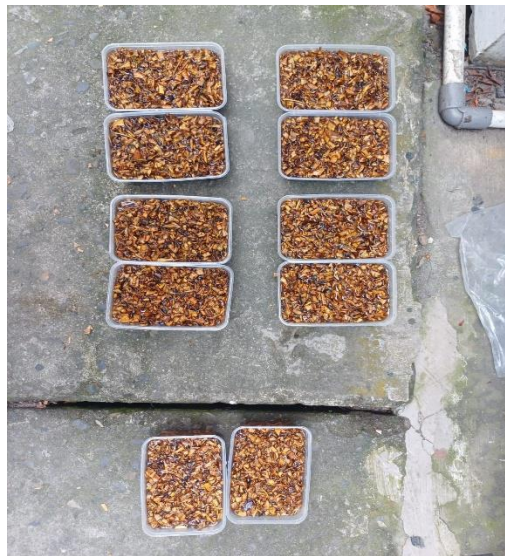
Gambar 3.14 Perendaman Daun Nanas Kering Menggunakan NaOH
