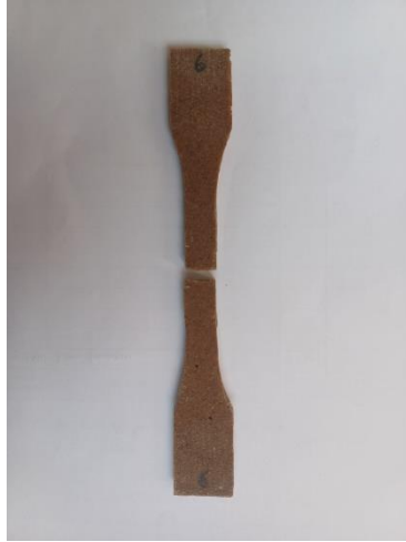
Gambar 4. 17 Spesimen sesudah uji tarik variasi 9 jam perendaman
