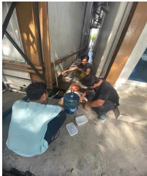
Gambar 3.17 Proses Pencampuran Serbuk Dengan Resin Epoxy
