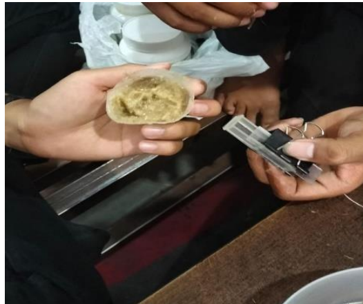
Gambar 3.20 Gambar Proses Penuangan Bahan Komposit Ke Dalam Cetakan
