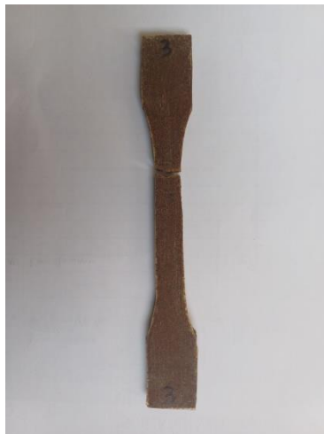
Gambar 4. 14 Spesimen sesudah uji tarik variasi 3 jam perendaman
