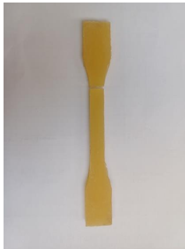
Gambar 4. 11 Spesimen sesudah uji tarik variasi tanpa serat (TS)
