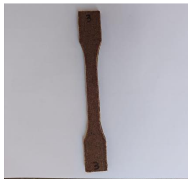
Gambar 4. 4 Spesimen 3 jam perendaman larutan alkali sebelum di uji
