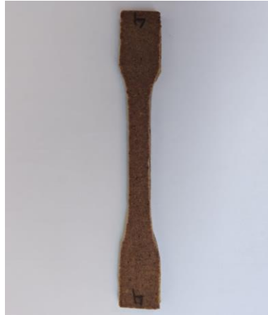
Gambar 4. 5 Spesimen 5 jam perendaman larutan alkali sebelum di uji
