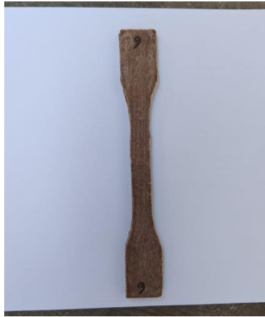
Gambar 4.7 Spesimen 9 jam perendaman larutan alkali sebelum di uji
