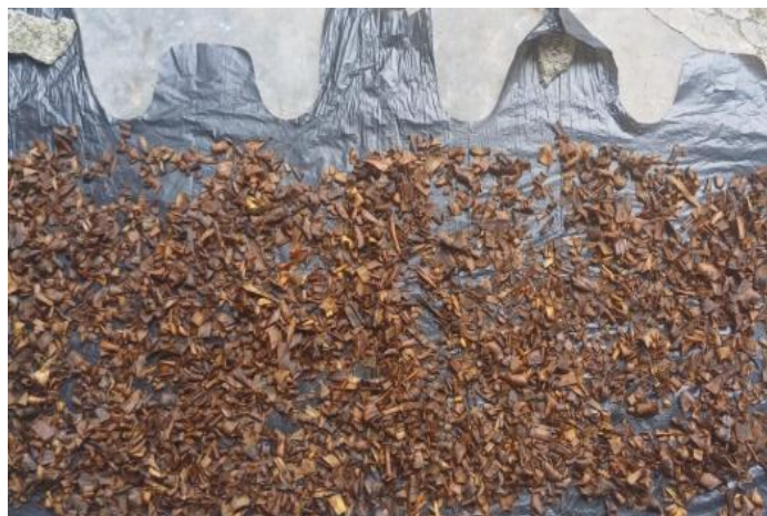
Gambar 3.15 Penjemuran Daun Nanas Setelah Perendaman NaOH
