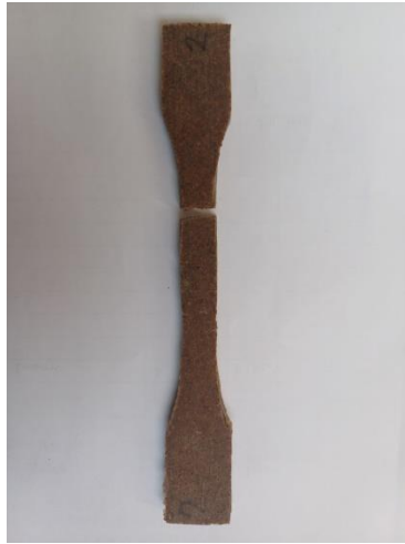
Gambar 4. 13 Spesimen sesudah uji tarik variasi 1 jam perendaman
