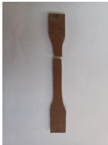
Gambar 4. 12 Spesimen sesudah uji tarik variasi tanpa perlakuan (TP)
