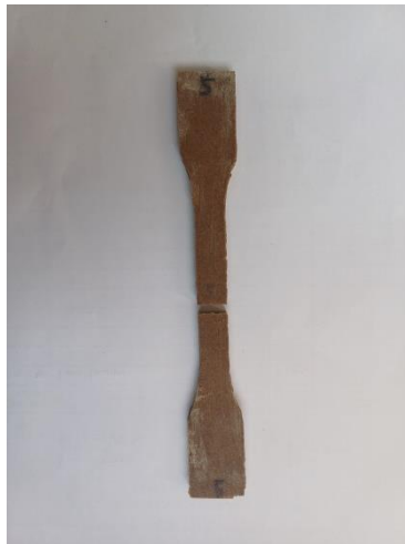
Gambar 4. 16 Spesimen sesudah uji tarik variasi 7 jam perendaman
