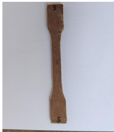
Gambar 4. 6 Spesimen 7 jam perendaman larutan alkali sebelum di uji
