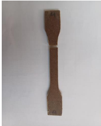
Gambar 4. 15 Spesimen sesudah uji tarik variasi 5 jam perendaman
