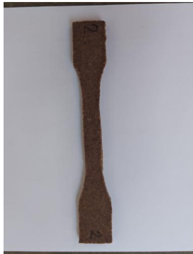
Gambar 4. 3 Spesimen 1 jam perendaman larutan alkali sebelum di uji
