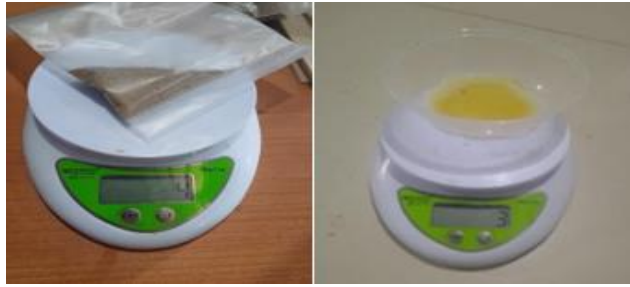
Gambar 3.18 Menimbang Serbuk Dan Resin Epoxy
