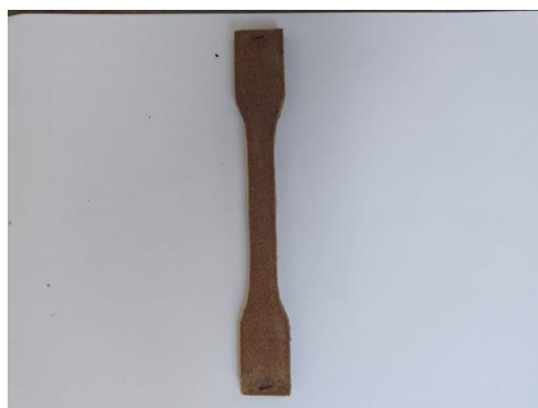
Gambar 4. 2 Spesimen tanpa perlakuan (TP) sebelum di uji
