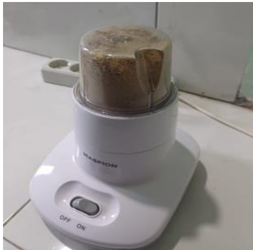
Gambar 3.16 Daun Nanas Di Blender Hingga Menjadi Serbuk
