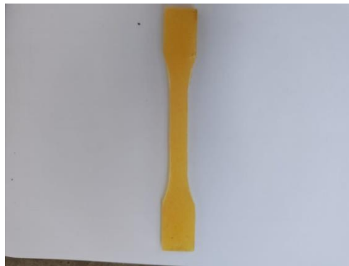
Gambar 4. 1 Spesimen tanpa serat (TS) sebelum di uji
