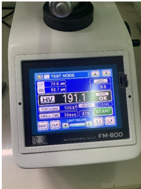
Hasil Quenching Dengan Media Udara (Weld Area)
