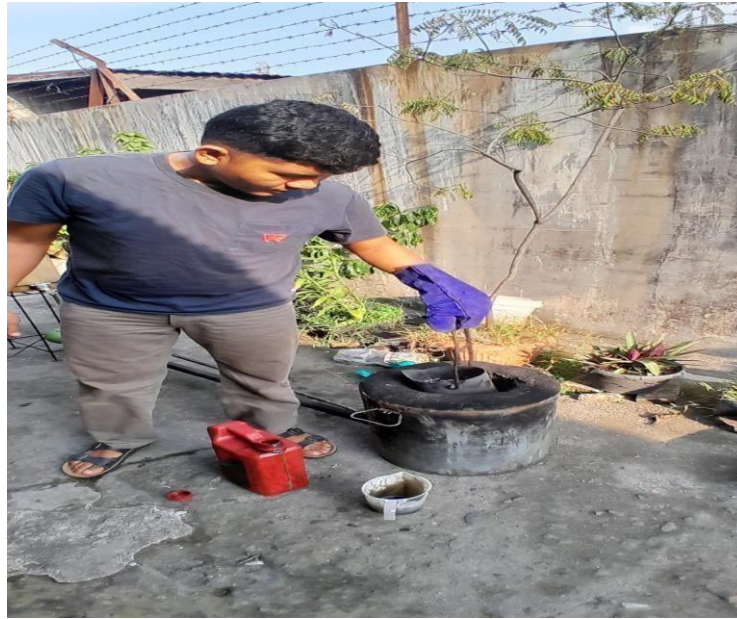
Gambar 3. 12 Menempatkan kowi ke tengah tungku peleburan
