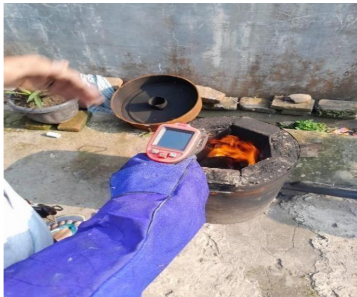
Gambar 3. 13 Proses pengukuran temperatur dengan thermogun infrared
