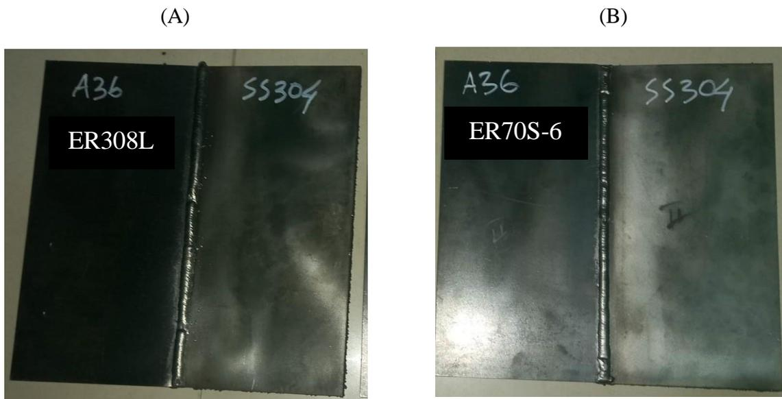
Gambar 4. 1 Hasil pengelasan dissimilar, (A): Filler ER 308L, (B): Filler ER70S-6
