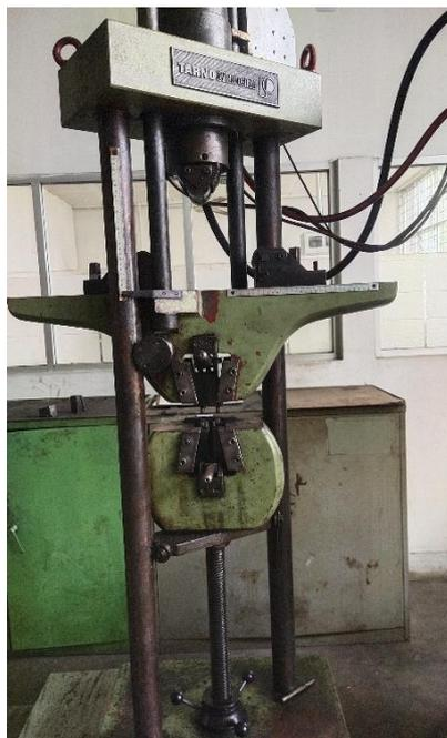
Gambar 2. 3. Mesin Uji Tarik
