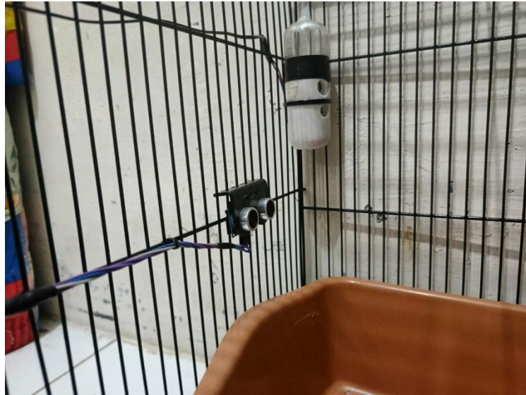
Gambar 4.3 Implementasi Sistem Monitoring dan Penanganan Bau Litterbox.
