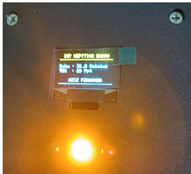
Gambar 4.9 Tampilan sensor TDS normal dengan kadar larutan 29 ppt
