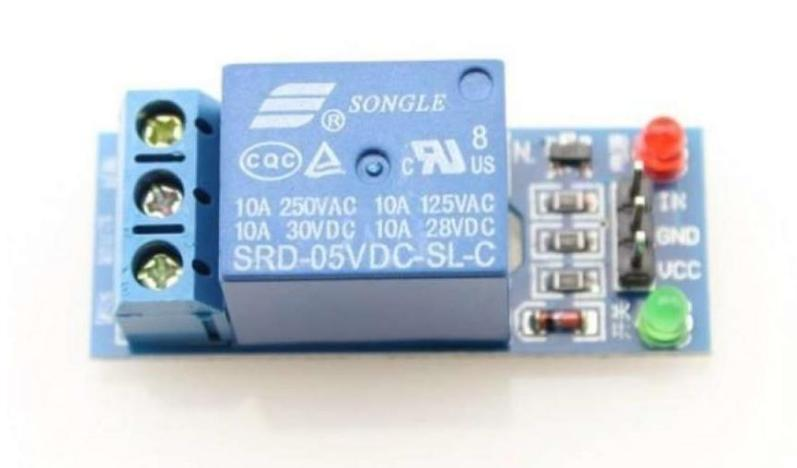
**Gambar 2.10 Modul Relay 250VAC/10A**
