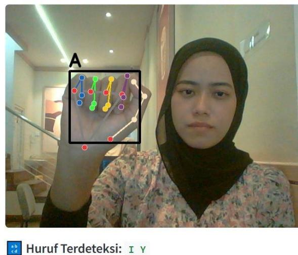
Gambar ini menampilkan proses deteksi tiga huruf yaitu "I", "Y", dan "A", yang membentuk kata "IYA". Hal ini menunjukkan sistem mampu mendeteksi rangkaian gesture secara runtut dengan hasil yang akurat
