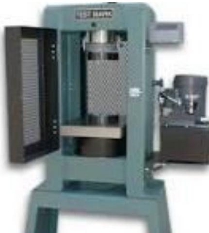
Gambar 3.2 Alat uji kuat tekan beton.
