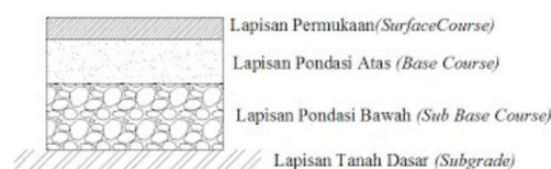
Gambar 2.3: Susunan lapisan perkerasan lentur (Direktorat jendral Bina Marga).
