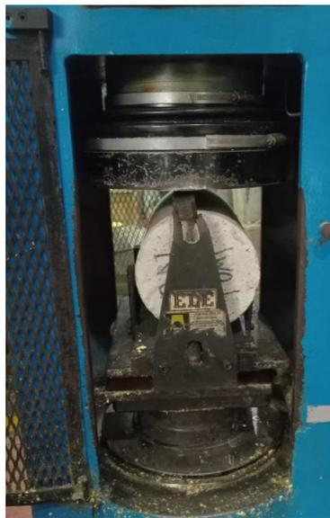
Gambar 3.6: Gambar Uji Kuat Tarik Belah Beton
