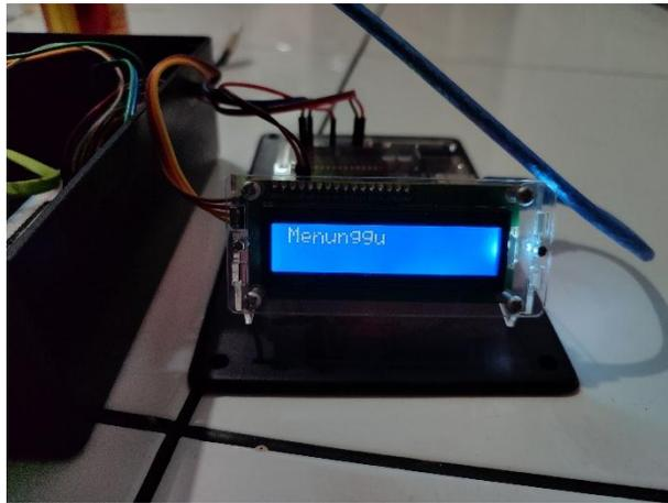
Gambar 4.7 LCD Ketika Sensor Tidak Mendeteksi Barang
