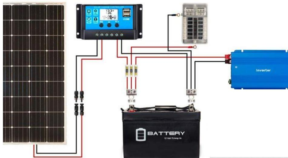
Gambar 2. 11 Sistem Instalasi Menggunakan PLTS (Stefanie and Bangsa 2021)
