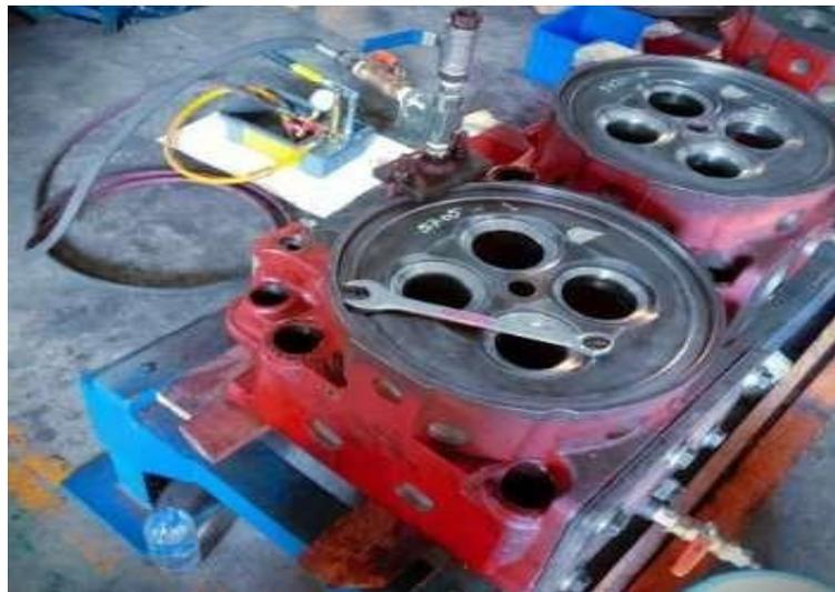
Gambar 4.29 Cek Kebocoran Bahan bakar
