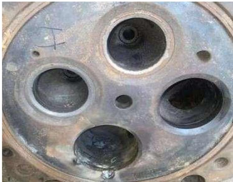
Gambar 4.24 Hasil Pengelasan *Cylinder Head*
