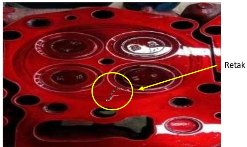
Gambar 4.21 Pengujian dengan *Colour Check* tahap 1
