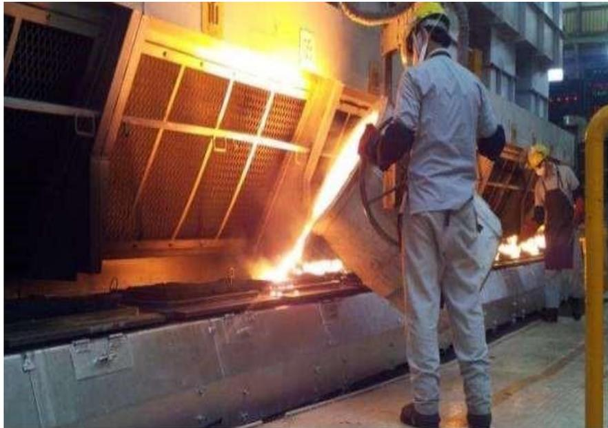
Gambar 2.2 Proses Pengecoran *Cylinder Head* (Dwi Karya Peleburan Logam)2015
