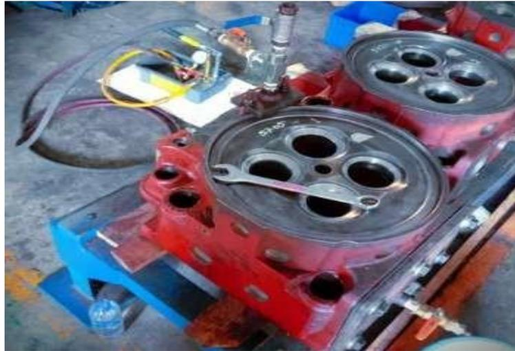
Gambar 4.23 Pengujian menggunakan *Test Press*
