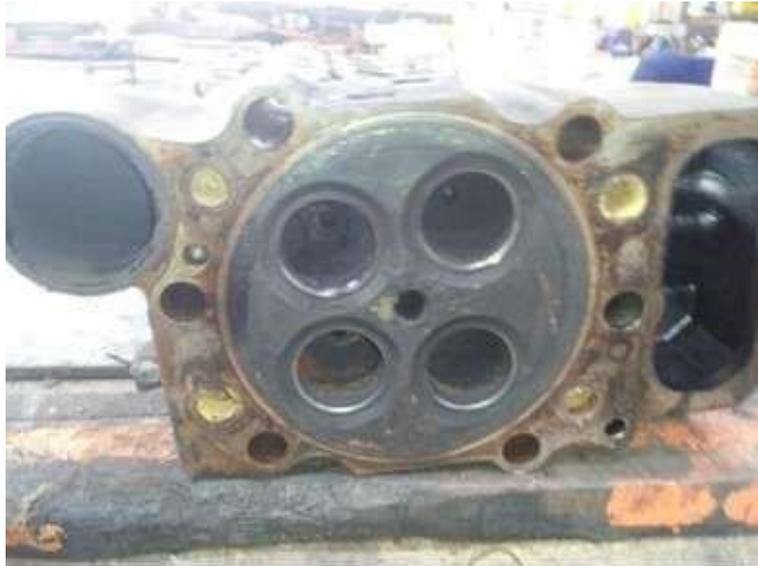
Gambar 4.17 Keretakan pada *Cylinder Head*
