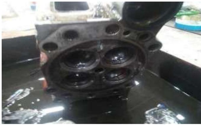
Gambar 4.19 Kondisi *Cylinder Head* Sebelum di *Cleaning*
