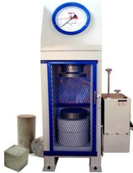
Gambar 3.5 : Mesin Uji Kuat Tekan Beton
