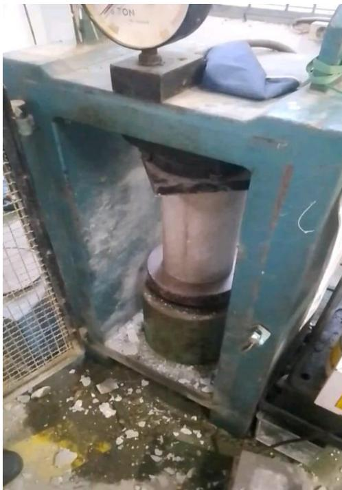
Gambar L- 14 Pengujian Kuat Tekan Beton
