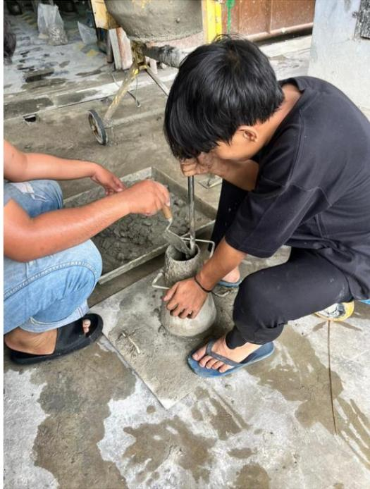
Gambar L- 9 Pengujian slump
