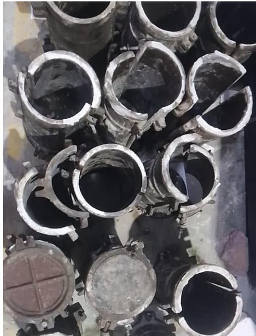
Gambar L- 2 cetakan silinder
