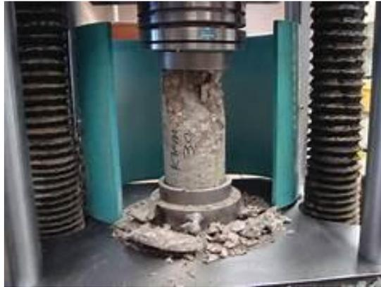
Gambar 3.5: Pengujian Kuat Tekan Beton.
