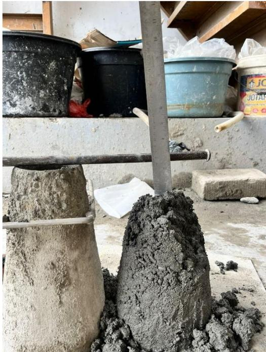
Gambar L- 10 Menghitung nilai slump
