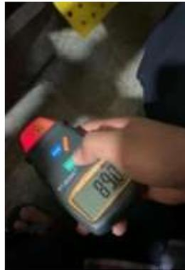
Gambar 4.4 Pada Kecepatan 89,8 RPM
