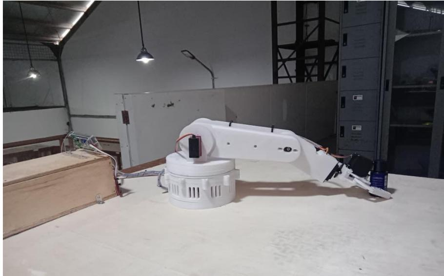
Dokumentasi: Proses pengujian gerakan angkat  $90^\circ$  pada ketinggian 0 cm
