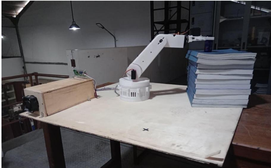
Dokumentasi: Proses pengujian gerakan angkat  $90^\circ$  pada ketinggian 20 cm
