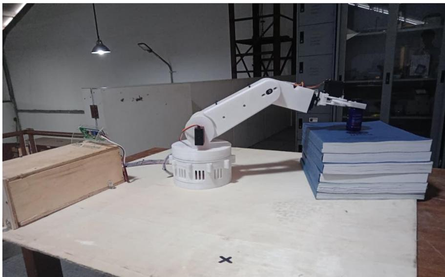
Dokumentasi: Proses pengujian gerakan angkat  $90^\circ$  pada ketinggian 10 cm
