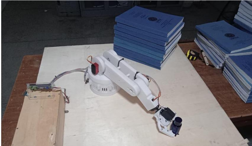
Dokumentasi: Proses pengujian *pick and place* untuk ketinggian 0 - 20 cm
