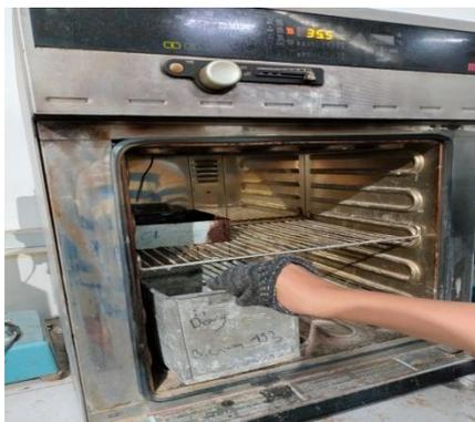
Gambar 3.48: Memasukkan pasir kedalam oven.
