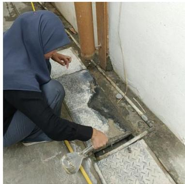
Gambar 3.30: Membuang air dalam piknometer.
