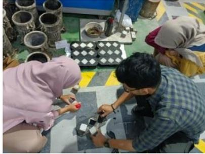
Gambar 3.107: Dokumentasi mengeluarkan benda uji mortar dari cetakan.
