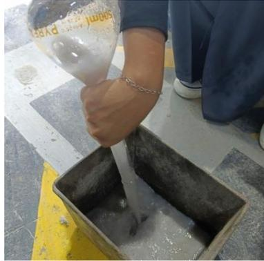
Gambar 3.34: Mengeluarkan abu sekam padi dari dalam piknometer.
