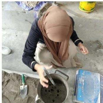
Gambar 3.58: Menusuk benda uji dengan tongkat pematik.
