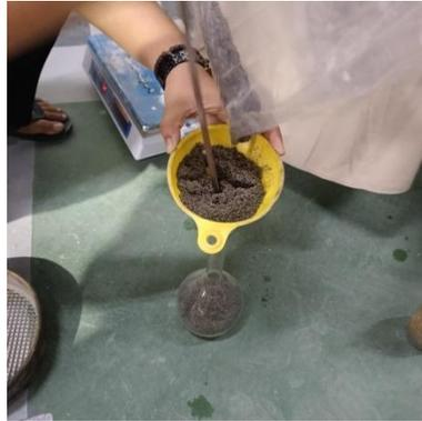
Gambar 3.44: Memasukkan pasir kedalam piknometer.
