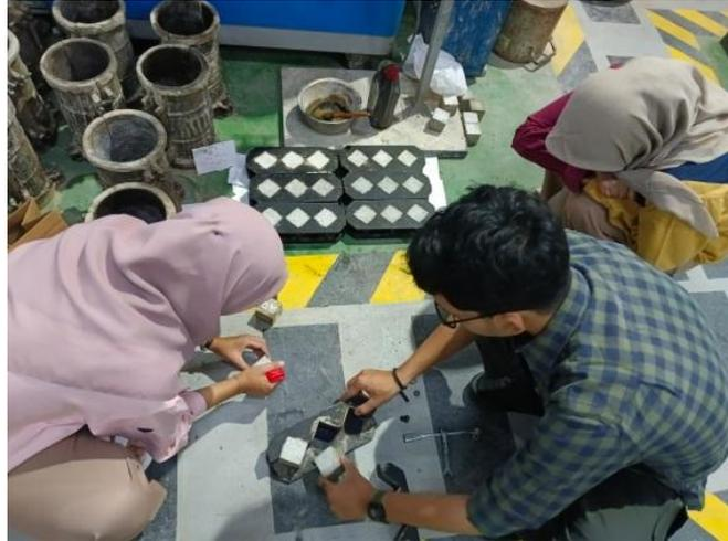
Gambar L.7: Proses mengeluarkan benda uji dari cetakan.
