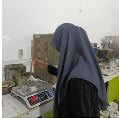
Gambar 3.29: Menimbang piknometer penuh air.
