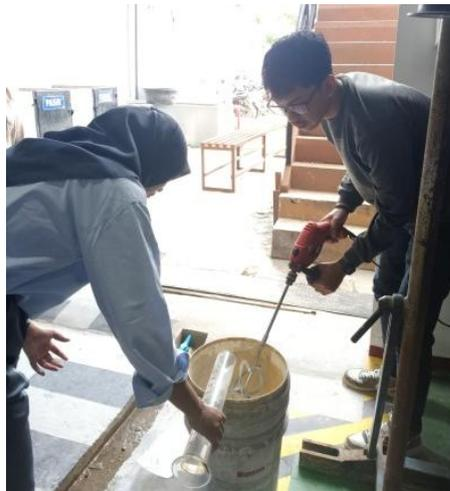
Gambar L.6: Proses pembuatan mortar.
