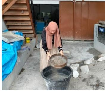
Gambar 3.72: Mengayak pasir dengan saringan no 4.
