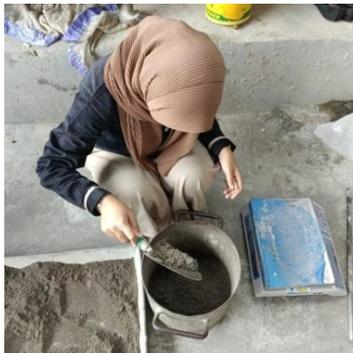
Gambar 3.55: Memasukkan contoh menggunakan sekop tangan ketinggian 5 cm.
