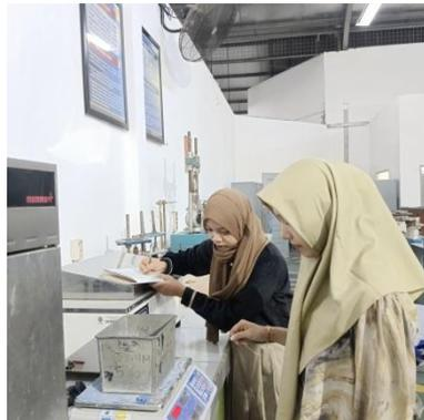
Gambar 3.49: Menimbang benda uji setelah dioven.
