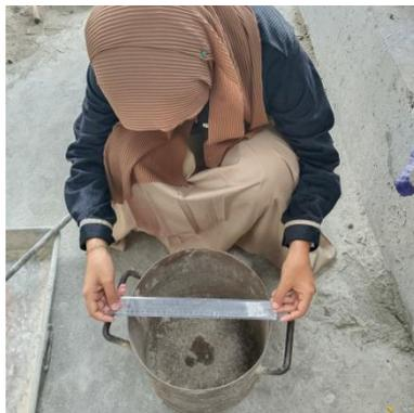
Gambar 3.54: Mengukur wadah baja.
