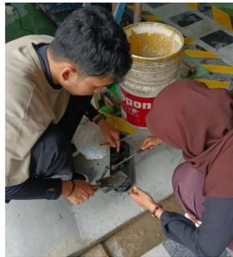
Gambar 3.100: Menuang adonan mortar ke dalam cetakan.
