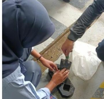
Gambar 3.88: Menuangkan adonan mortar kedalam cetakan.
