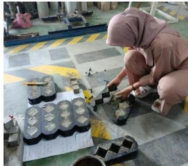
Gambar 3.103: Membuka cetakan setelah 24 jam.
