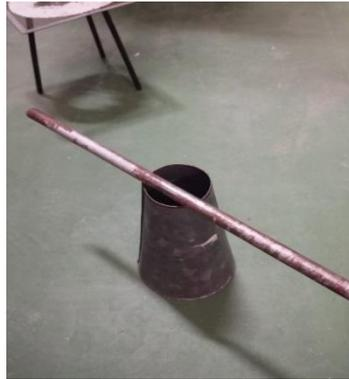
Gambar 3.14: Cetakan kerucut pasir dan tongkat pemadat.
