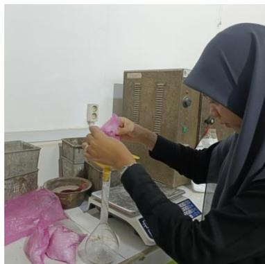
Gambar 3.31: Memasukkan abu sekam padi kedalam piknometer.
