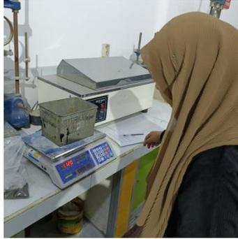
Gambar 3.75: Memasukkan pasir basah ke dalam wadah dan menimbangya.
