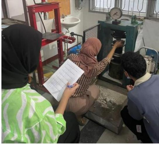
Gambar L.10: Proses pengujian kuat tekan.
