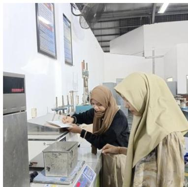
Gambar 3.36: Menimbang benda uji setelah dioven.
