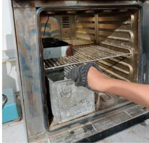
Gambar 3.78: Memasukkan kembali benda uji kedalam oven.
