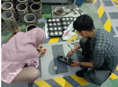
Gambar 3.91: Membuka cetakan mortar.
