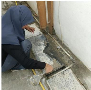
Gambar 3.43: Membuang air dalam piknometer.
