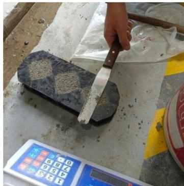
Gambar 3.89: Meratakan permukaan mortar.
