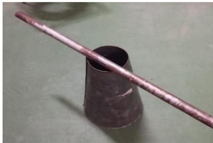
Gambar 3.39: Memasukkan contoh pasir kedalam cetakan kerucut pasir.
