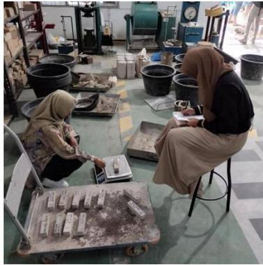
Gambar 3.111: Menimbang benda uji setelah perendaman.
