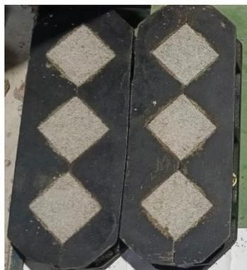
Gambar 3.90: Mendiamkan sampel dalam cetakan selama 24 jam.
