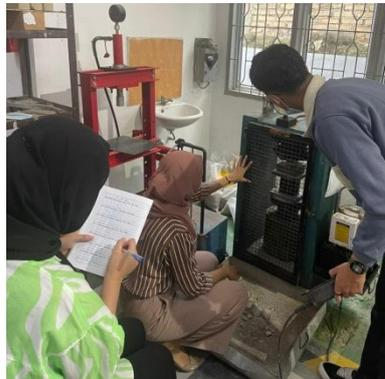
Gambar 3.94: Melakukan pengujian kuat tekan.
