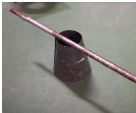
Gambar 3.40: Mengangkat cetakan kerucut pasir secara perlahan.
