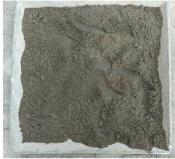
Gambar 3.38: Menjemur agregat halus.
