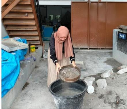
Gambar 3.65: Menyaring pasir dengan saringan no 4.
