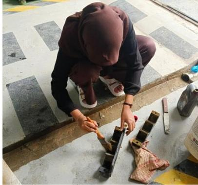
Gambar 3.99: Mengoles cetakan menggunakan oli.
