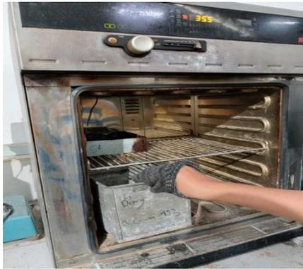
Gambar 3.35: Memasukkan abu sekam padi kedalam oven.
