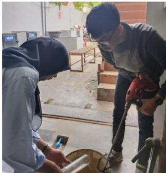
Gambar 3.86: Memasukkan air kedalam adonan mortar.
