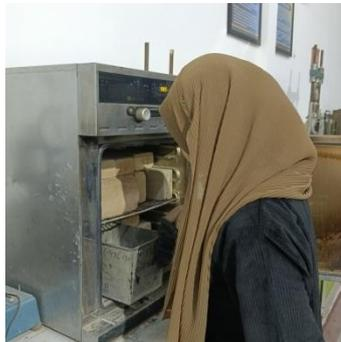
Gambar 3.76: Memasukkan sampel ke dalam oven.
