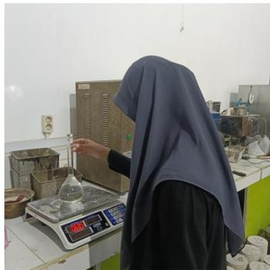
Gambar 3.42: Menimbang piknometer penuh air.
