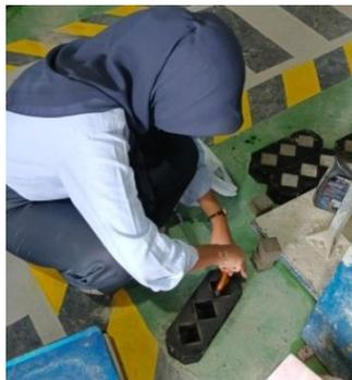
Gambar 3.87: Mengoles cetakan dengan oli.
