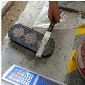
Gambar 3.101: Meratakan permukaan mortar.
